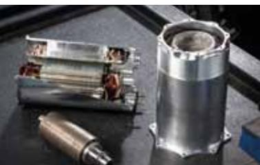
*Hinten links ein Schnitt vom E-Motor, vorne links ein Rotorrund, rechts ein eingepresster Stator*
