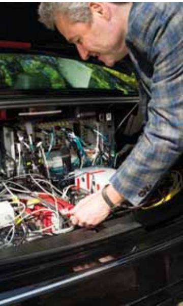
*Im Kofferraum sitzt die Technik, an die Daten vom GPS-Gerät gesendet werden*
