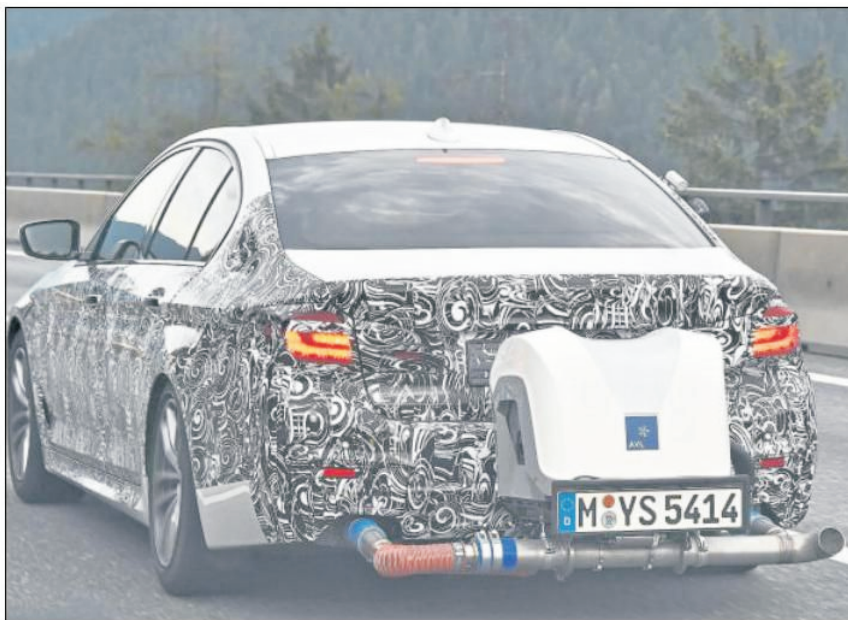
TESTRUCKSACK: Die Anlage am Heck – hier an einem BMW-Erkönig – misst den Schadstoffausstoß im Straßenverkehr statt im Labor. Foto: Hora
