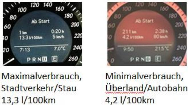
**Abbildung 33: Spannweite des Fahrzeugverbrauches bei einer Normangabe von 6,0-6,5 l/100km. Die Verbrauchsspannweite ist bedingt durch Individualisierungsmöglichkeiten der Fahrzeuge (Reifen, Fahrwerk, Ausstattungsumfänge, ...)**
