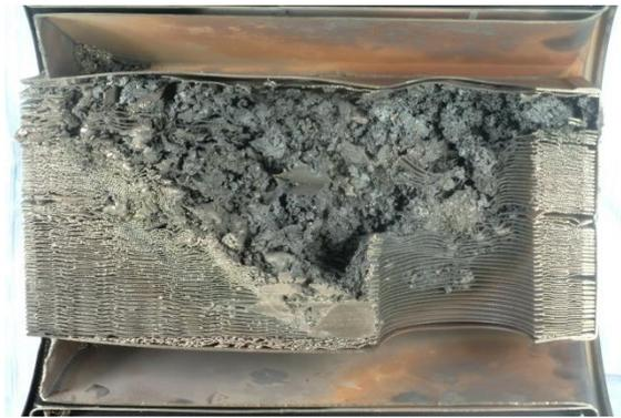
**Abbildung 2: Folgen einer unerwünschten Partikelfilterregeneration, DPF - Durchbrand
