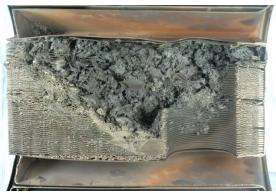
Abbildung 2: Folgen einer unerwünschten Partikelfilterregeneration, DPF - Durchbrand Rußbeladung = 100 [g], T<sub>Regeneration</sub> = 650 [°C] [6]
